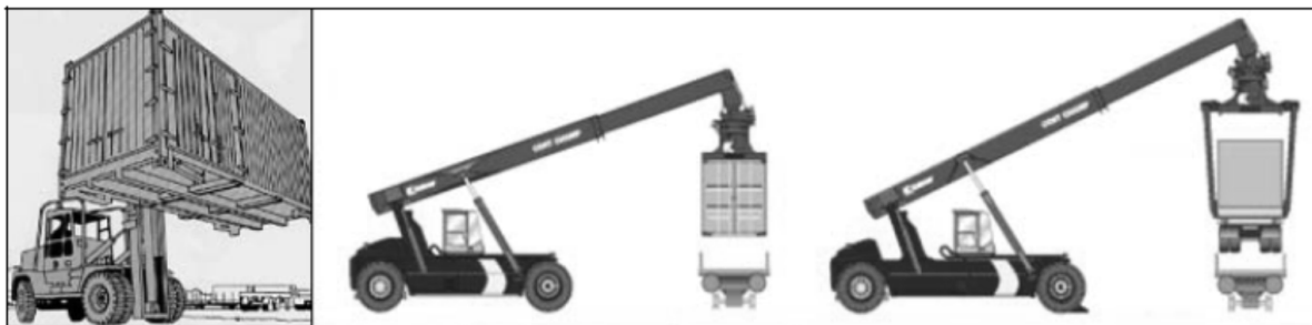
Figur 3-9 Gaffeltruck - løfter under, reachstackers løfter med toppløft (hovedsakelig containere) eller ved hjelp av gripearmer (semihengere). Kilde: (Hovedplan Byggetrinn 1 - teksthfte UAC-00-A-11048, 2011)
