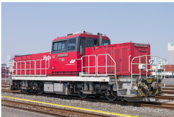
Figur 36: Japan Rail (JR) Freight's diesehybrid benytter Li-ion-basert batteriteknologi (til venstre). Denne, samt JR-persontog også som diesehybrid, ble satt i drift i 2010 og nytt materiell i 2015 (til høyre).
