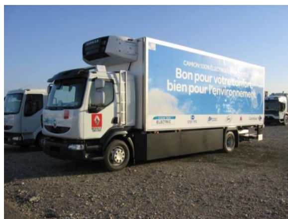
Figur 7: Varebiler med hybrid fremdriftssystem (batterier og hydrogen) på 3,5 tonn er allerede under uttesting av det franske postvesenet, og lastebiler på opptil 19 tonn skal testes ut i 2016 (SymbioFCell/Renault).
