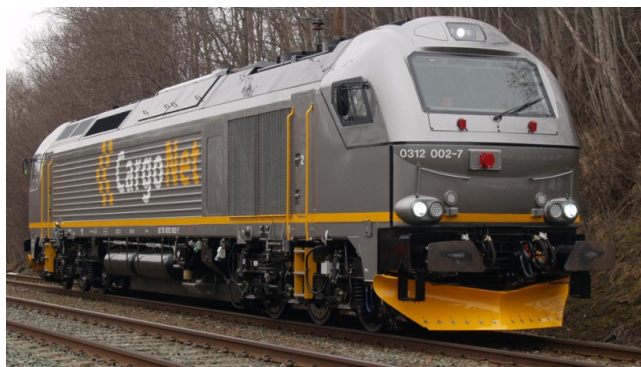
Figur 8: Dieselelektrisk lokomotiv av typen Vossloh España Euro4000, som er i bruk i Norge med betegnelse CD 312.
