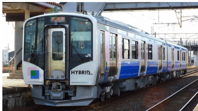
Figur 36: Japan Rail (JR) Freight's diesehybrid benytter Li-ion-basert batteriteknologi (til venstre). Denne, samt JR-persontog også som diesehybrid, ble satt i drift i 2010 og nytt materiell i 2015 (til høyre).
