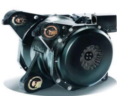
Figur 6: MITRAC permanent-magnet motor produsert av Bombardier installert i REGINA (Gröna Tåget) (30).
