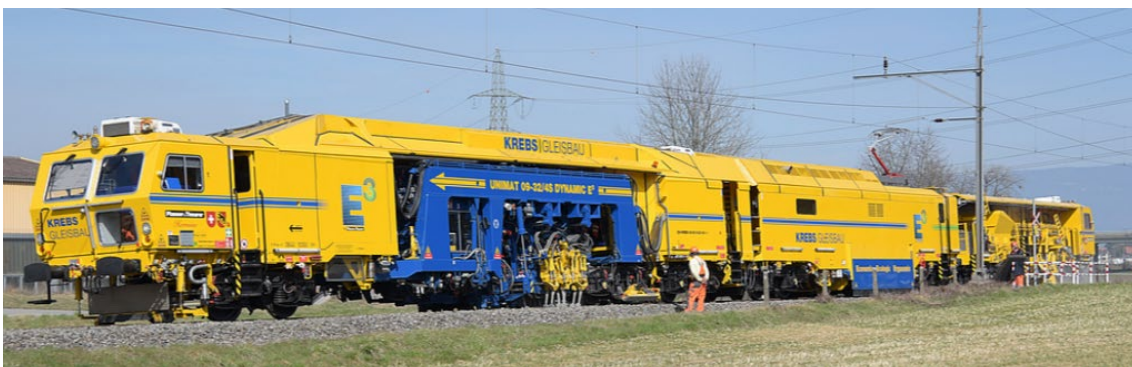
Figur 2: Unimat 09-32/4S Dynamic E 3 pakkmaskin fra Plasser&Theurer, for drift fra KL og batteri.
