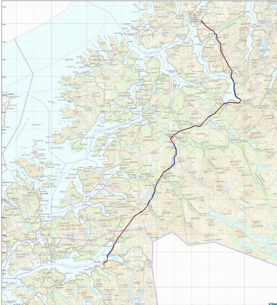
Figur 5-1 Oversiktskart Narvik-Tromsø. Utsnitt fra Quantm som viser hvor omtrent det blir dagsoner (blå), tunneler (rød) og bruer (grå).
