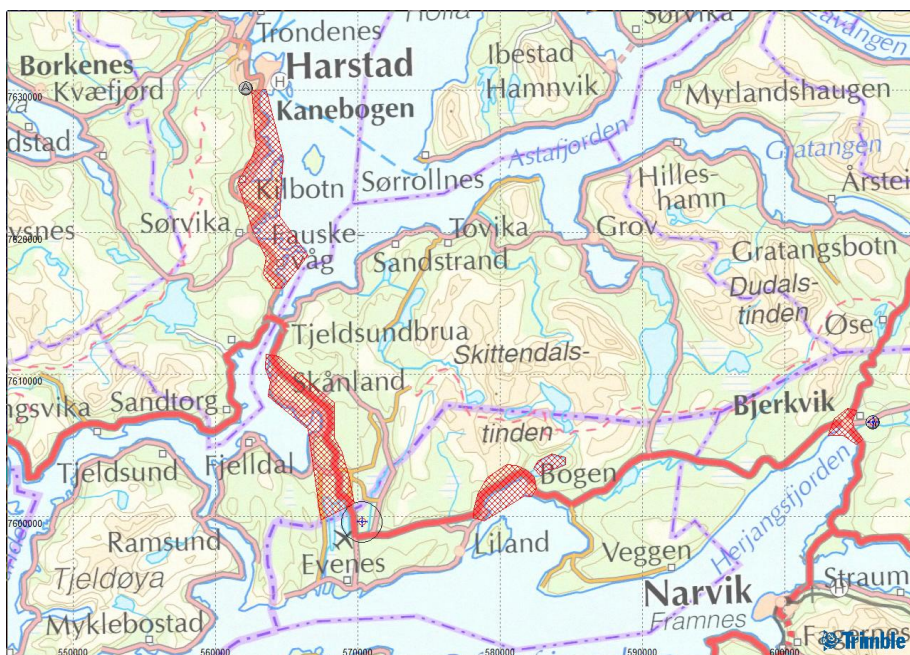
Figur 6-2 Bildet viser utgangspunktet for Quantm-søkene. Rødmargerte soner guider traséen utenom områder som ikke er ønsket, f.eks. eksisterende infrastruktur.
