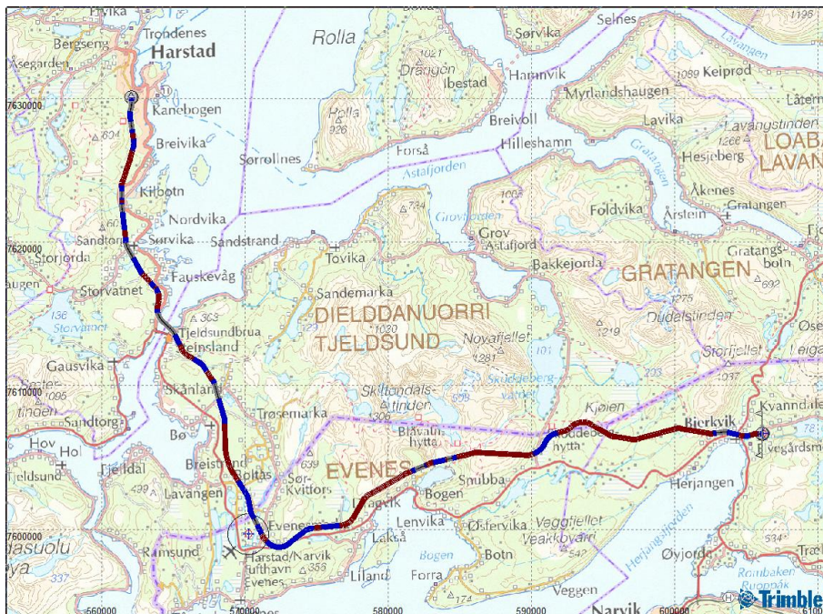
Figur 6-1 Oversiktskart Bjerkvik-Harstad. Utsnitt fra Quantm som viser hvor omtrent det blir dagsoner (blå), tunneler (rød) og bruer (grå).
