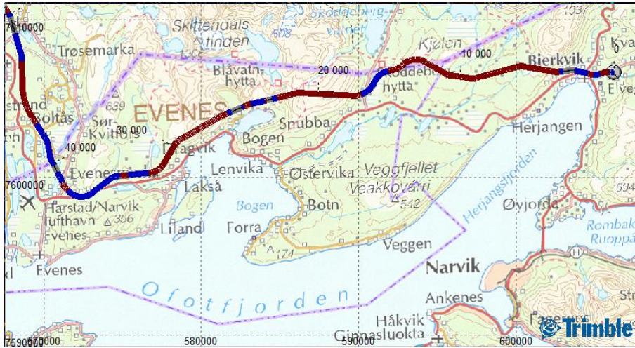
Figur 6-3 Passering av Bogen. Utsnitt fra Quantm som viser hvor omtrent det blir dagsoner (blå), tunneler (rød) og bruer (grå).
