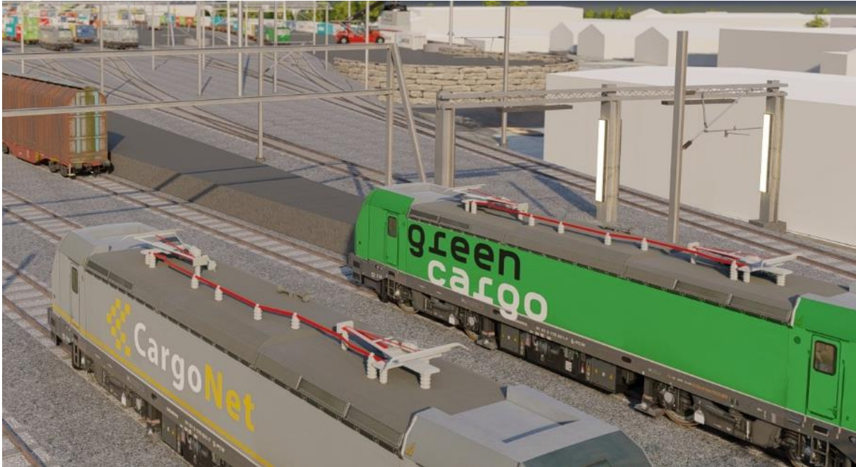
Figur 33 - Portal for togskanning vist helt til høyre over spor 8 og 9
