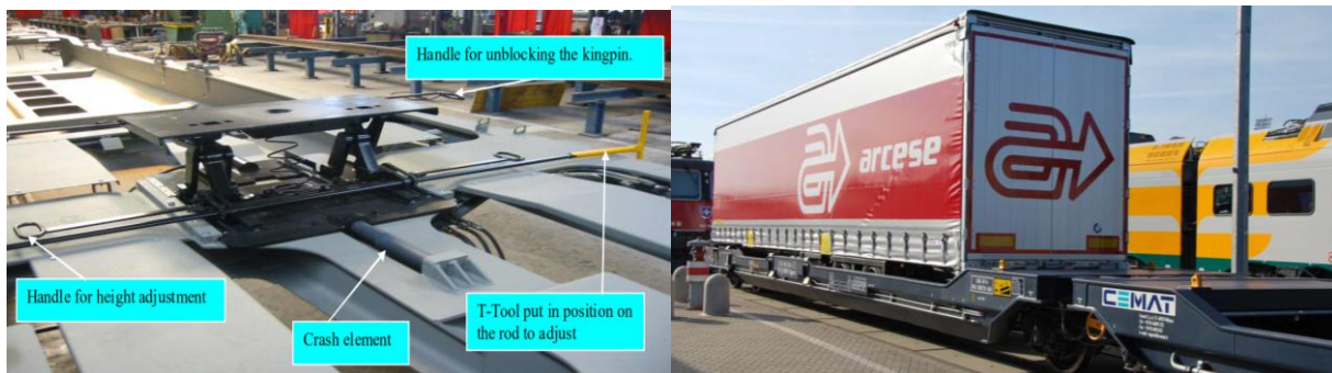
Figur 34 - T3000e dobbel pocketvogn med kingpinlås (Ferriere Cattaneo)
