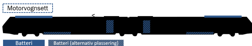
Figur 18: Eksempel på plassering av batteri på et to-vogns motorvognsett
