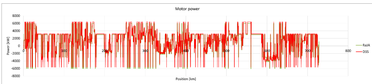
Figur 146: Sammenligning av simuleringsresultat. Godstog, nordgående, batteri (konsept 3). Effektforkbruk fra motorer.
