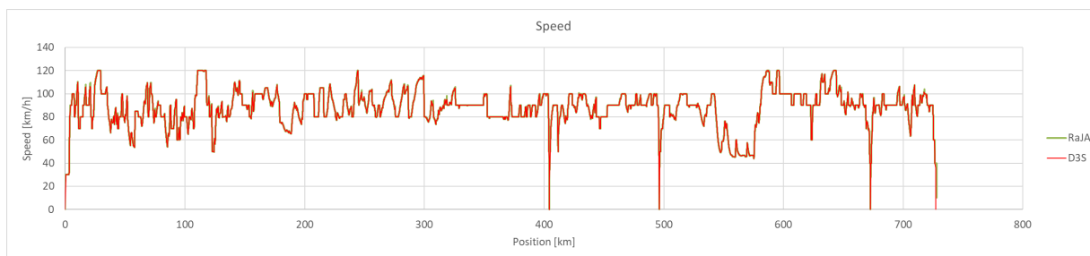
Figur 119: Sammenligning av simuleringsresultat. Godstog, nordgående, hydrogen (konsept 2a). Hastighet.
