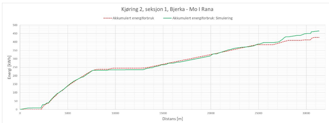
Figur 40: Validering - Kjøring 2, seksjon 1. Akkumulert energiforbruk. (Togvekt 1012 tonn og korreksjonsfaktor på C med 0,5)
