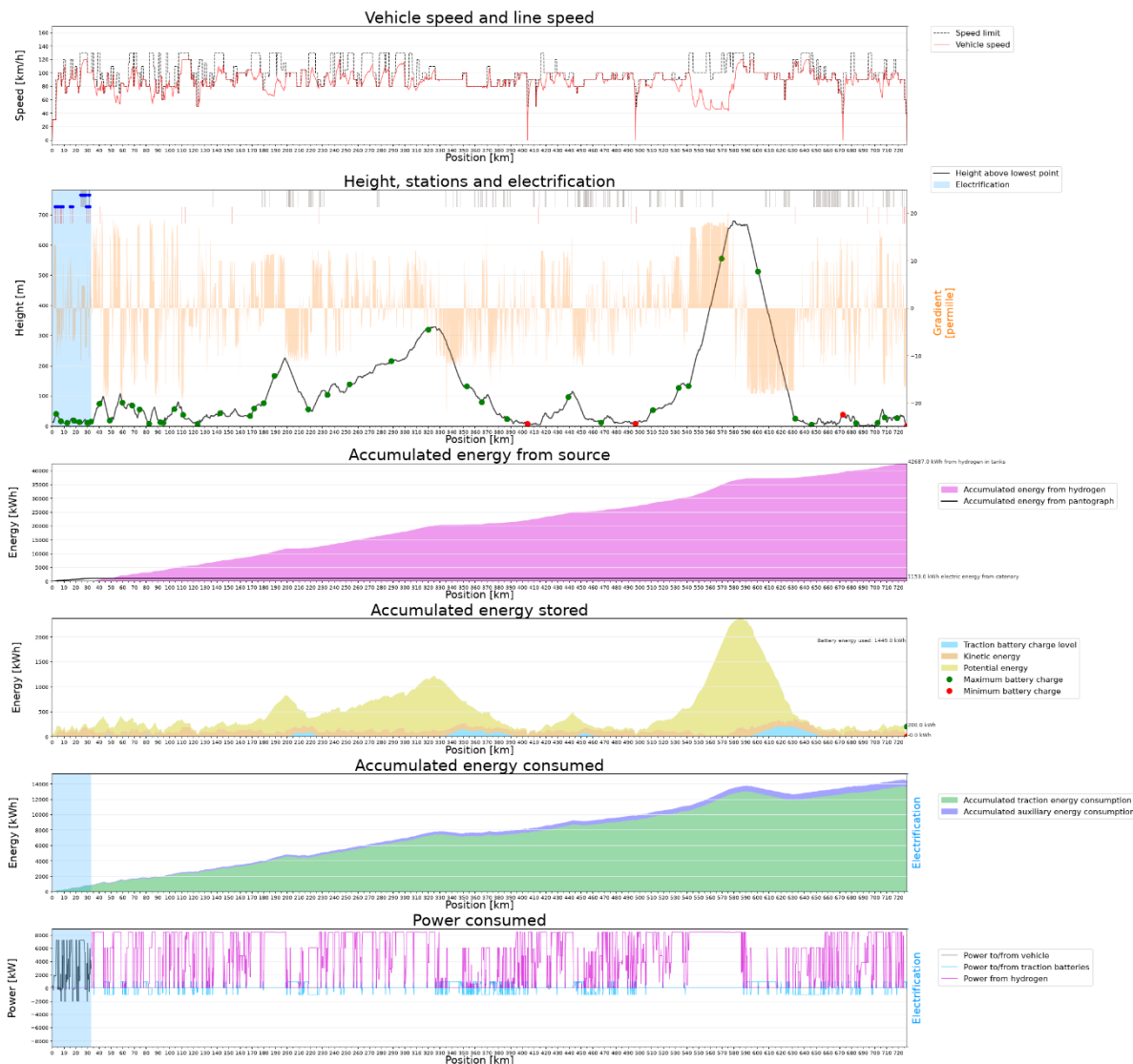
Figur 81: Simuleringsresultat for godstog GK25a, Trondheim – Bodø med konsept 0, diesel. Grå ruter i graf nr 2 viser tunneler, og røde strek viser overgangsbruer. Blå prikk betyr at tunnelen eller overgangsbroen er på elektrifisert strekning.
