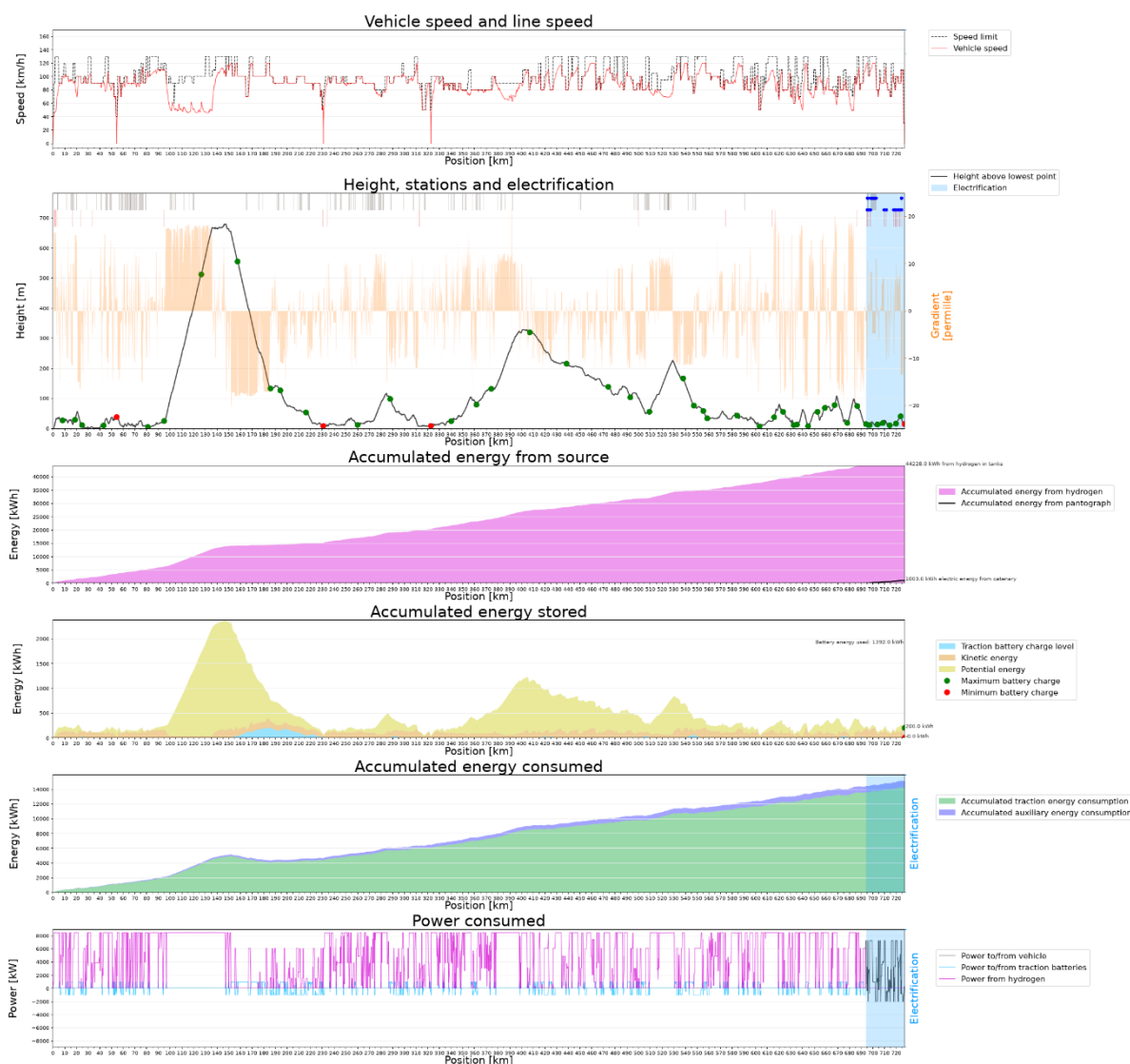
Figur 82: Simuleringsresultat for godstog GK25a, Bodø–Trondheim med konsept 0, diesel. Grå ruter i graf nr 2 viser tunneler, og røde strek viser overgangsbruer. Blå prikk betyr at tunnelen eller overgangsbroen på elektrifisert strekning.
