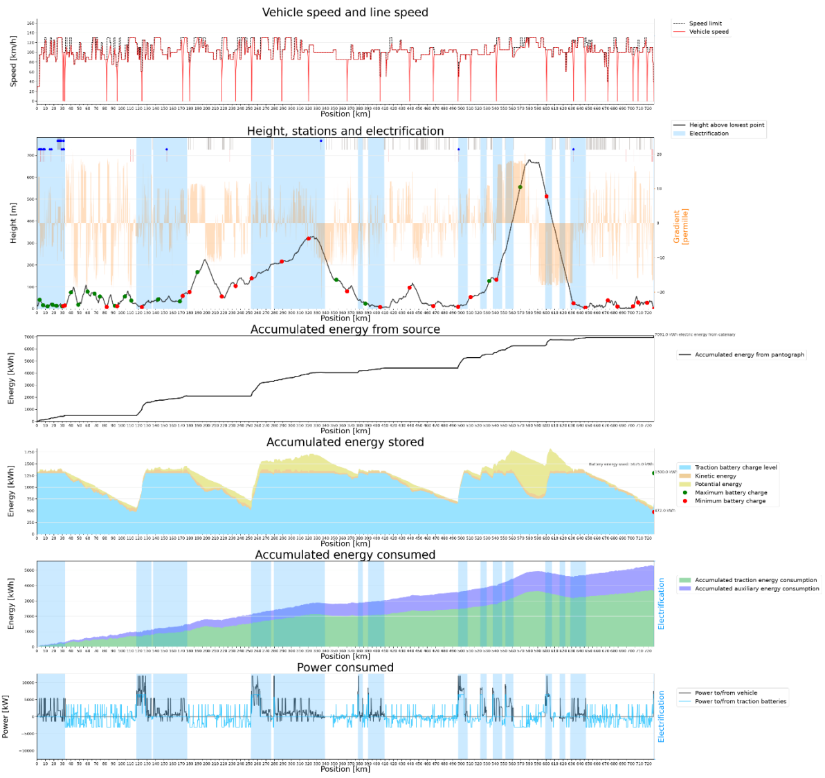
Figur 108: Simuleringsresultat for fjerntogslinje F7, Trondheim-Bodø. Normalt hjelpekraftforbruk (200 kW) og normal kjøremotstand.
