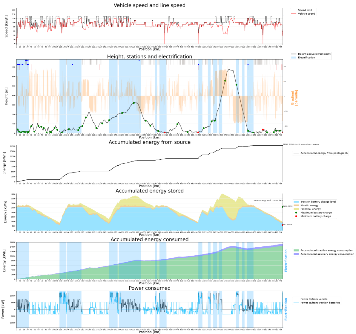
Figur 94: Simuleringsresultat for godstog GK25a, Trondheim – Bodø med konsept 3, batteri. Grå ruter i graf nr 2 viser tunneler, og røde strek viser overgangsbruere. Blå prikk betyr at tunnelen eller overgangsbroen er på elektrifisert strekning.
