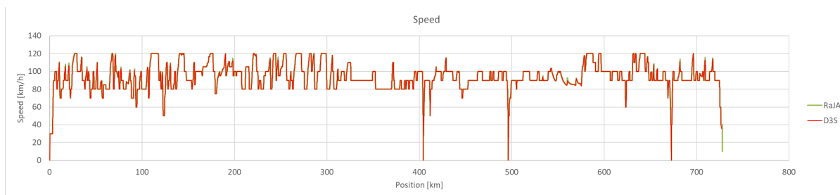
Figur 157: Sammenligning av simuleringsresultat. Godstog, nordgående, elektrifisering (konsept 4). Hastighet.
