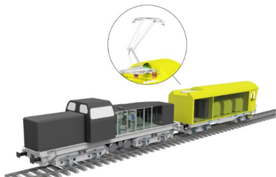
Figur 50: Eksempel på løsning for batterivogn som skal levere strøm til lokomotiv. Kilde: Railcare Group AB.
