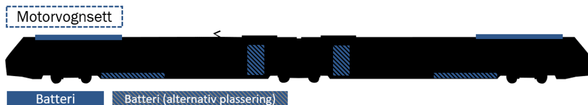
Figur 29: Eksempel på plassering av batteri på et togvognsett motorvognsett.
