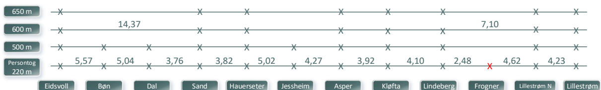
Figur 5-2 Avstander mellom kryssingsspor Eidsvoll-Lillestrøm for tog med ulik lengde. Avstander er angitt i kilometer. Kryss i rødt: På Frogner stasjon er det ikke mulighet til rutemessig kryssing av persontog, da stasjonsutformingen ikke muliggjør passasjerutveksling i begge retninger.
