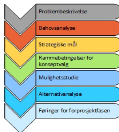
Figur 1-2. Fasene i arbeidet med KVV for økt kapasitet.
