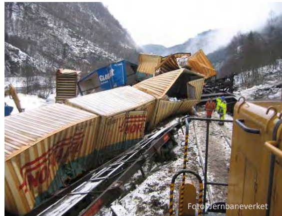
Figur 2.24 Uluikka ved Seimsvatn i 2008 der det til alt hell var eit godstog og ikkje persontog som spora av som følgje av stein i skinnegangen.
