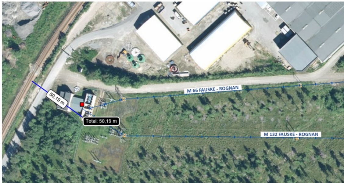
Figur 5 Utsnitt fra NVE Atlas med målsatt avstand mellom Rognan transformatorstasjon og jernbanelinje. [1]
