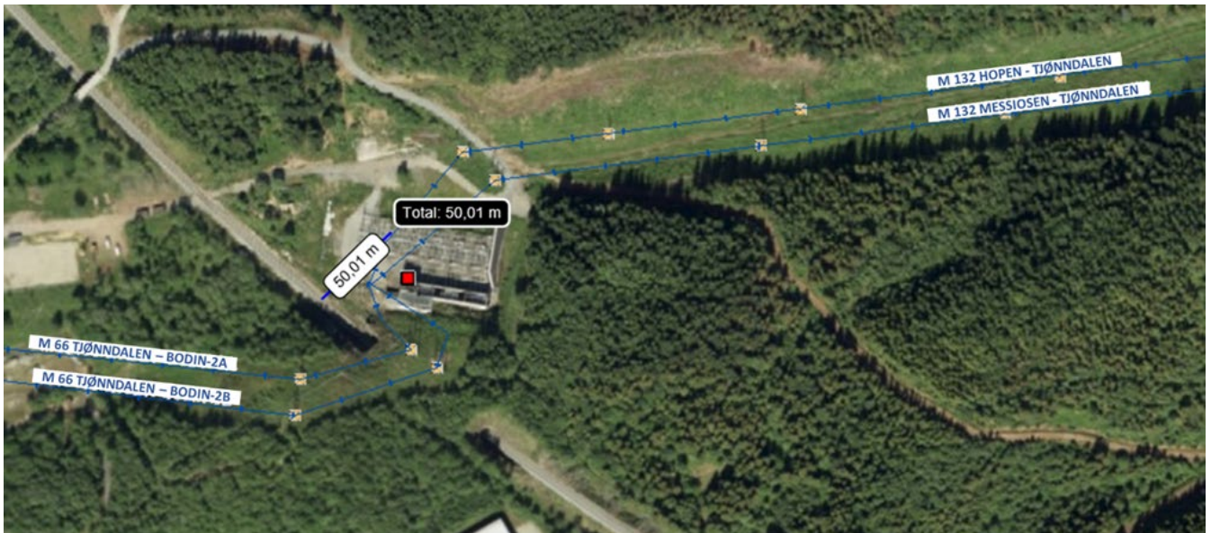
Figur 6 Utsnitt fra NVE Atlas med målsatt avstand mellom Tjønndalen transformatorstasjon og jernbanelinje. [1]
