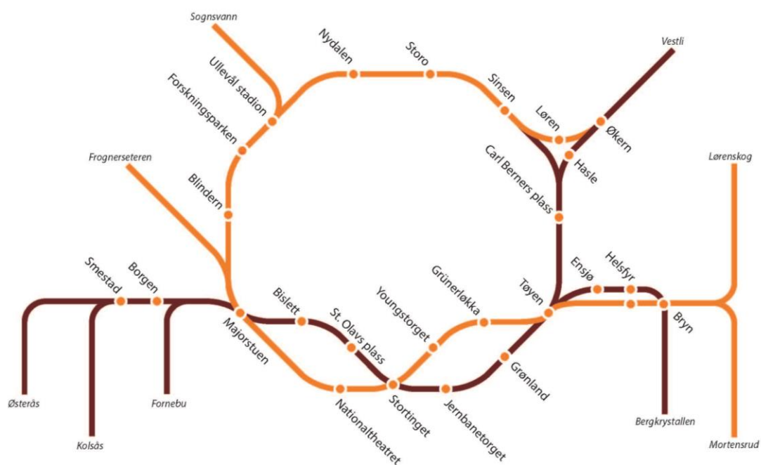
Figur 13-6 Anbefalt prinsipp for metrosystemet. Ny metrotunnel Majorstuen–Bryn knyttes sammen med dagens tunnel på Stortinget.
