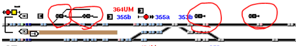
Figur 10: Innsetting av nye signaler for å optimalisere blokkstrekninger
