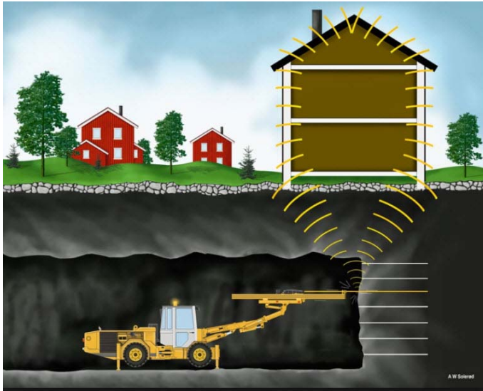
Figur 18: Strukturlyd i bygning fra boring i tunnel. (Illustrasjon fra Statens Vegvesen, Arild W. Solerød)
