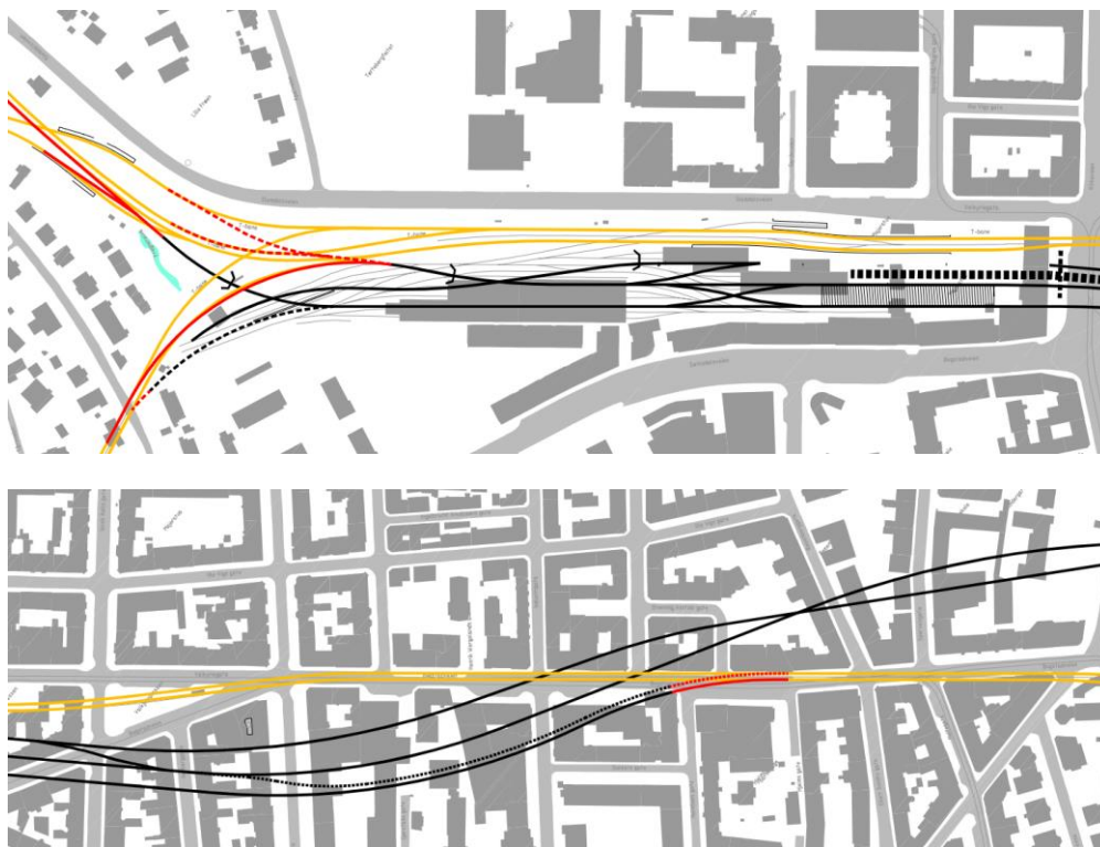
Figur 37: Kobling etter første utbyggingsfase. Sort er ferdig anlegg, oransje er spor i drift, rød er kritisk kobling.
