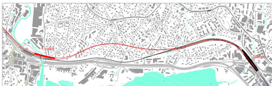
Figur 58: Oversiktstegning for ny lokaltogspor mellom Skøyen og Lysaker stasjon (jernbanetrasé for regiontog bruker eksisterende bane)
