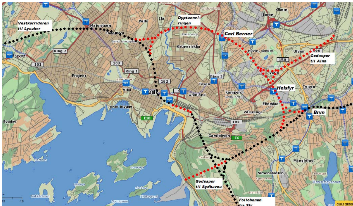
Figur 3.2 Forslag fra Gamle Oslo Arbeiderparti om nye tunneler (markert med røde prikker) og tunneler som forsagstiller oppfatter at Jernbaneverket planlegger men dypere (markert med svarte prikker).
