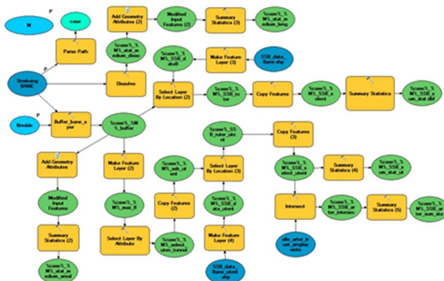
Figur V-2 Modell i ArcGIS Model Builder som tillater en delvis automatisering av analysen. Figuren viser modellen for å beregne de ulike alternativene for jernbanen. En tilsvarende modell ble laget for veistrekningene.
