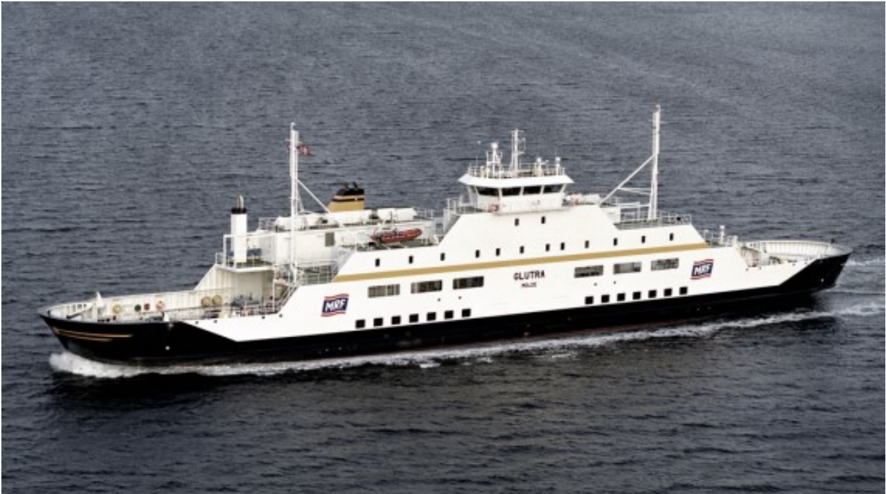
Figur 34: LNG ble introdusert som drivstoff for bilferger i 2000 med M/F Glutra, og er senere benyttet på en rekke ferger og skip. Erfaringene med tanke på sikkerhet gjennom de første 20 år har generelt vært gode [144].
