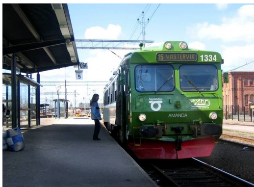
Figur 24: Biogasstoget Amanda som gikk mellom Linköping og Västervik, ombygget fra diesel (til venstre). General Electrics ombygde diesellokomotiv til naturgass (til høyre).
