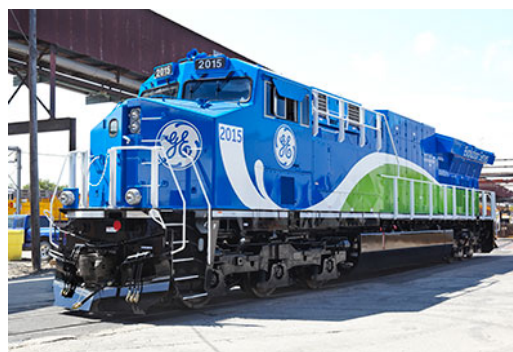
Figur 24: Biogasstoget Amanda som gikk mellom Linköping og Västervik, ombygget fra diesel (til venstre). General Electrics ombygde diesellokomotiv til naturgass (til høyre).
